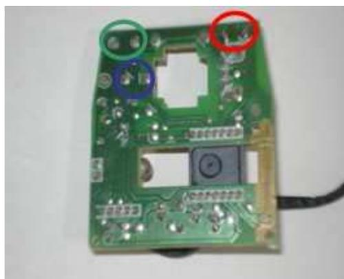
Soldamos un cable a dos de las patas de cada micropulsador como se muestra a continuación.
