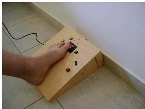
La adaptación fue fabricada a partir de un mouse convencional, que debe ser desarmado, una caja de madera, algunas soldaduras, y unos pocos
